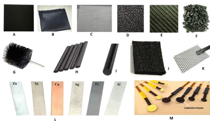
Фиг. 4. Широк набор от често използвани конвенционални материали прилагани като аноди в микробиални горивни клетки [6]
