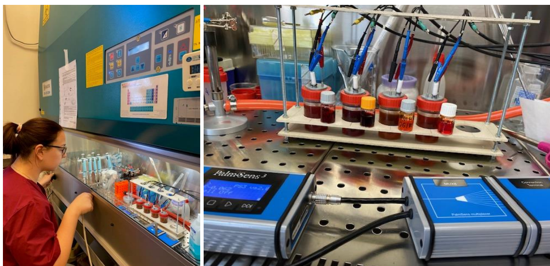
Фиг. 8. Опитна постановка: провеждани експерименти за образуване на биофилм (ляво) и изпитание на подобрите багрила като екзогенни медиатори на електронен пренос от бактериите до електрода на БЕС ( дясно).
