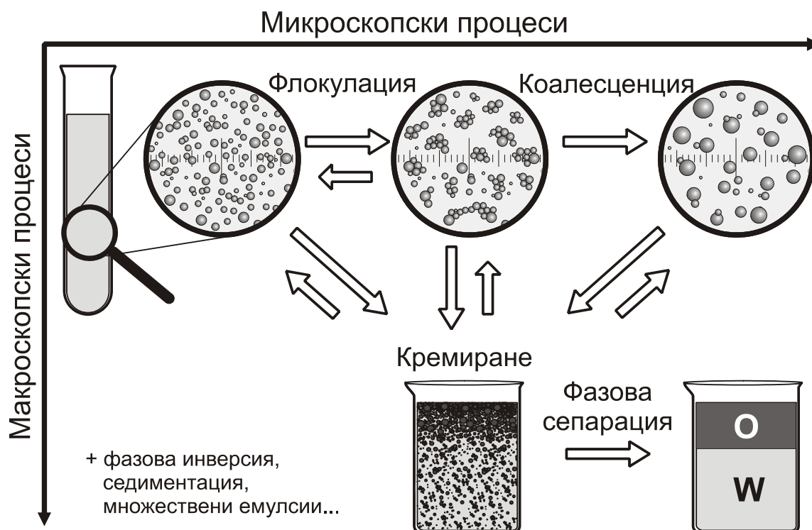
Фигура 1. Схема на процесите на дестабилизация на емулсионните системи
